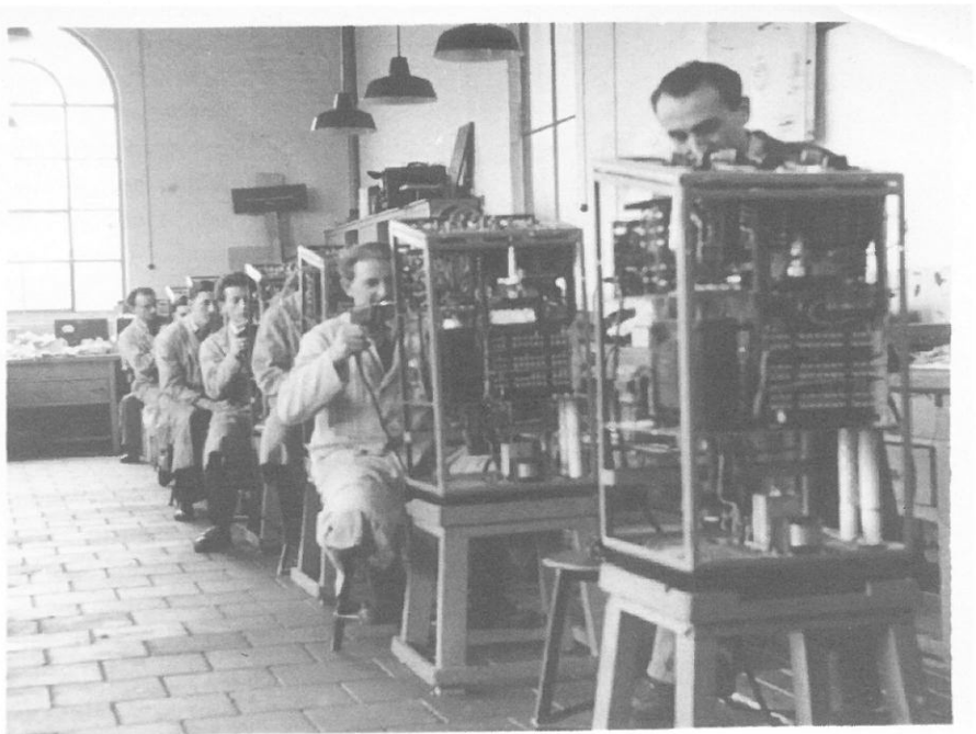
Productie van schakeltafels voor de röntgenapparatuur; de jaren dertig-versie van de steriele productieafdelingen voor chips in onze tijd.
