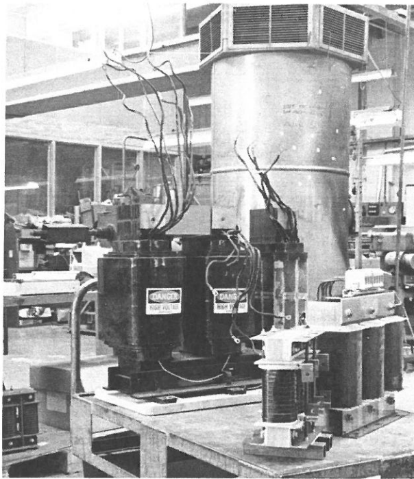
Twee nieuw gebouwde en één gereviseerde trafo van Radar meetapparatuur voor baancontrole van satellieten die om de aarde lopen.
