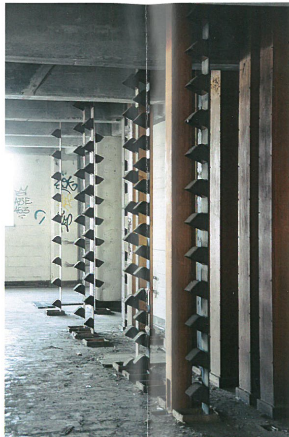
In de schoonmakerij werd graan naar boven getransporteerd via deze schepbakjes in houten kokers. Aan de voorzijde zijn de houten kokers verwijderd en zie je de lege bakjes op weg naar beneden. Dit gebouw had dezelfde houten vloeren als de molengebouwen, maar de draagconstructie was gewapend beton.
