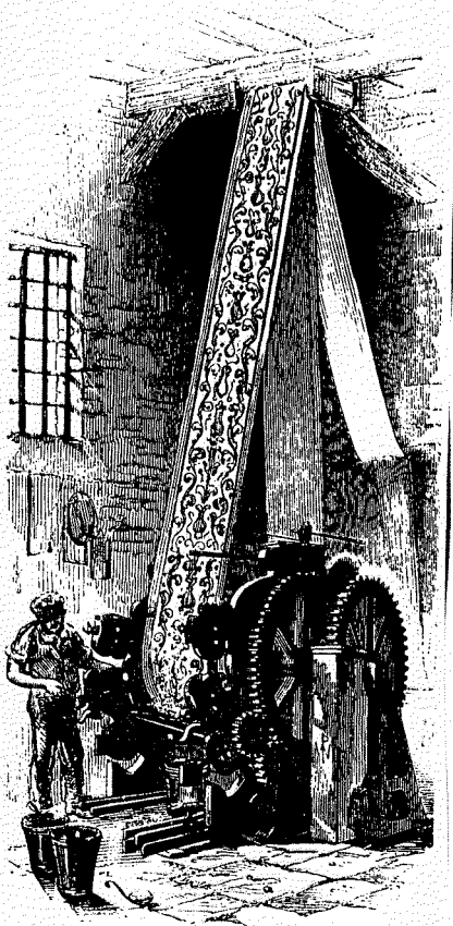
Doorsnede van een perrotine, omstreeks 1850. (GTN III, 61).
