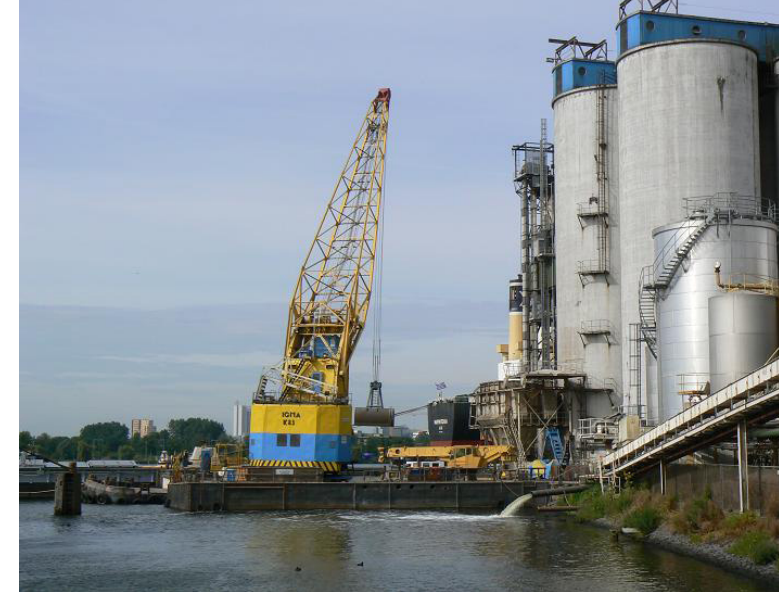
Drijvende kampnagel ex FS nu kraan 83 van de IGMA aan het werk in de Vlothaven te Amsterdam.
