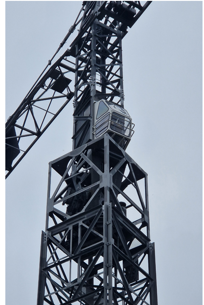
De Richier-Weitz bouwkraan met kabine en hefmechaniek Foto: Helmig Kleerebezem, 24-02-2026
