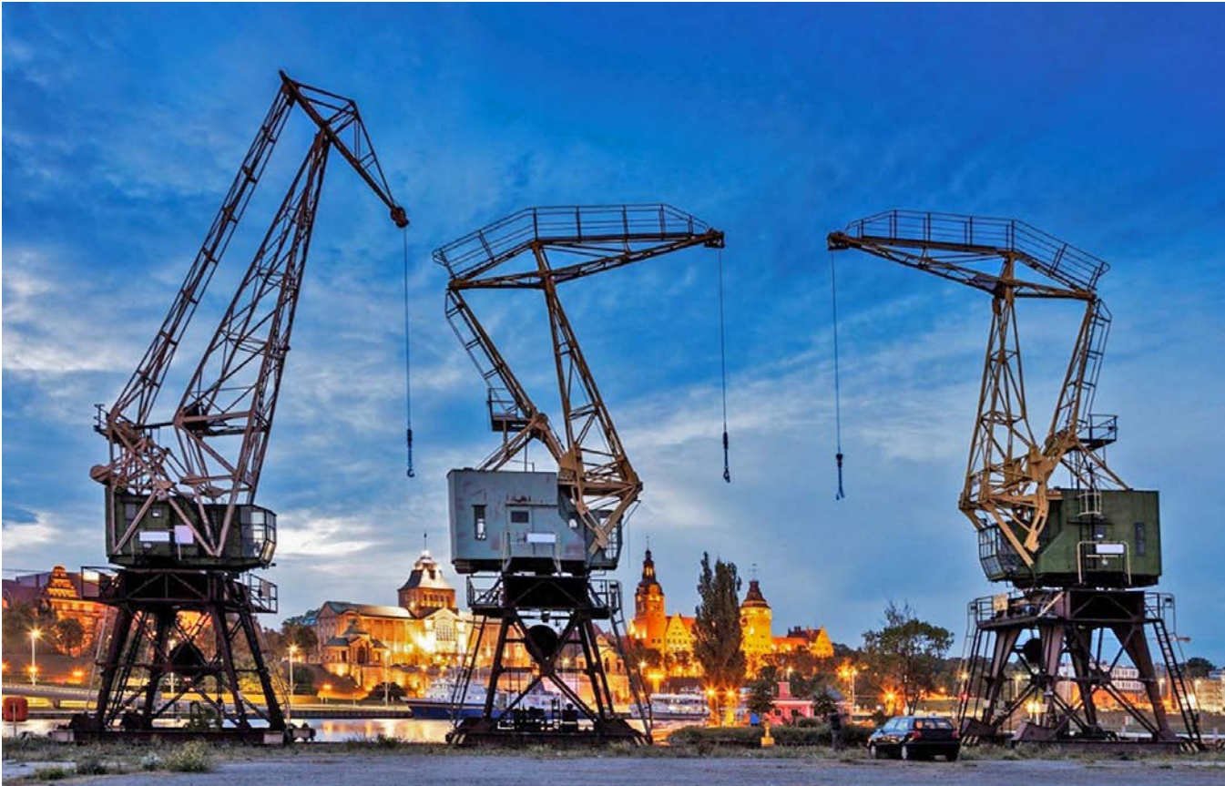
▲ De Cranosaurussen van Szczecin. Links een tuimelarmkraan en rechts twee lemniscaatkranen uit 1929 gebouwd door Krupp. Szczecin - ZEROMUR
