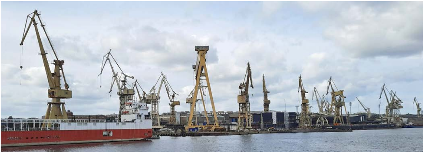
▲ De Cranosaurussen van Szczecin. Links een tuimelarmkraan en rechts twee lemniscaatkranen uit 1929 gebouwd door Krupp. Szczecin - ZEROMUR
