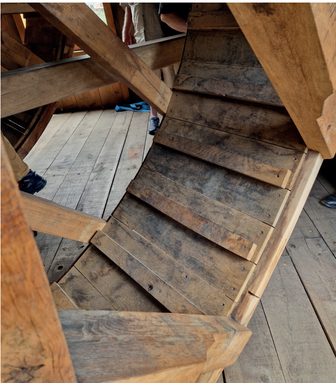
Ter weerszijden van de spil zijn de tredaderen opgesteld, waarmee de kraan met menskracht wordt aangedreven. Onder een detal. 19-06-2025 Foto's: Helmig Kleerebezem
