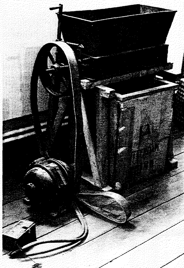
Afb.14: Theebreekmachine van Engelse makelij. Tussen twee draaiende metalen walsen werd de thee gebroken. (Museum de Theefabriek te Houwerzijl)
